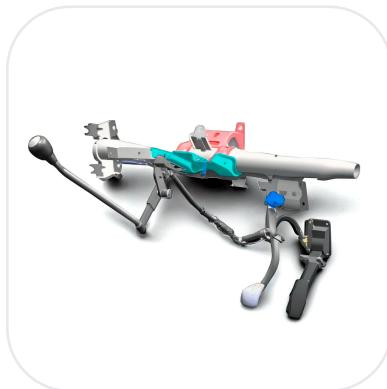
Рычаг с левой стороны от рулевого колеса отвечает за управлением функциями «газа» и «тормоза». Конструкция разработана и протестирована с участием людей с физическими ограничениями.
