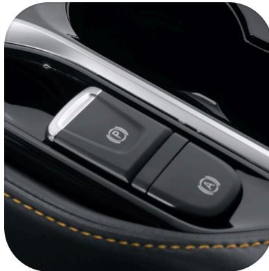
Autohold - система автоматического удержания автомобиля с использованием стояночного тормоза с электроприводом. Функция особенно полезна для водителей с ограниченными физическими возможностями: при активации Autohold во время коротких остановок, в том числе на светофорах, автоматически срабатывает стояночный тормоз с электроприводом, что освобождает водителя от необходимости удерживать автомобиль путем постоянного давления на рычаг ручного привода.
