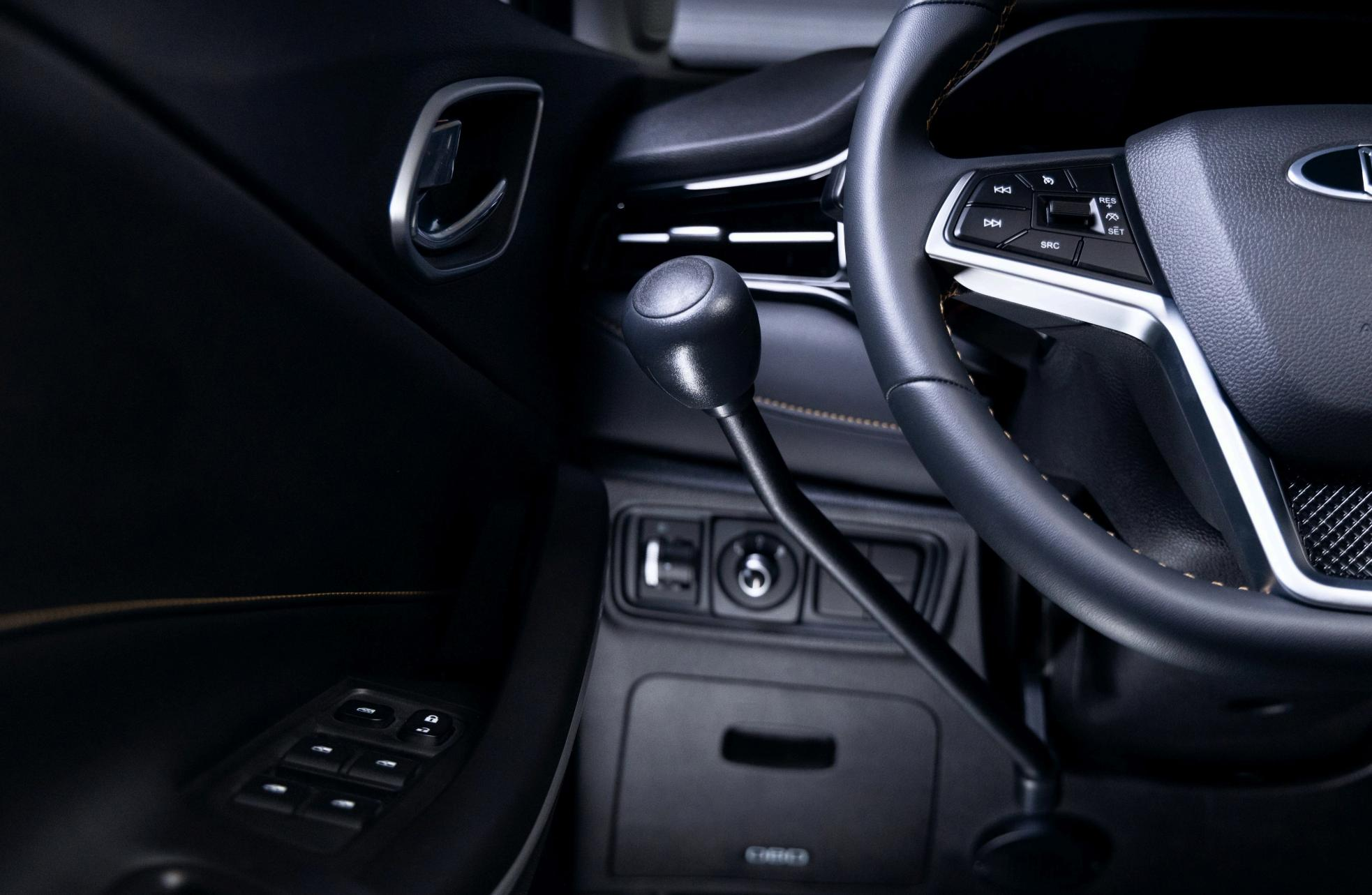
Рычаг слева от руля позволяет управлять функциями «газа» и «тормоза». Для ускорения нужно потянуть его на себя, для торможения — переместить в противоположном направлении, от себя.
